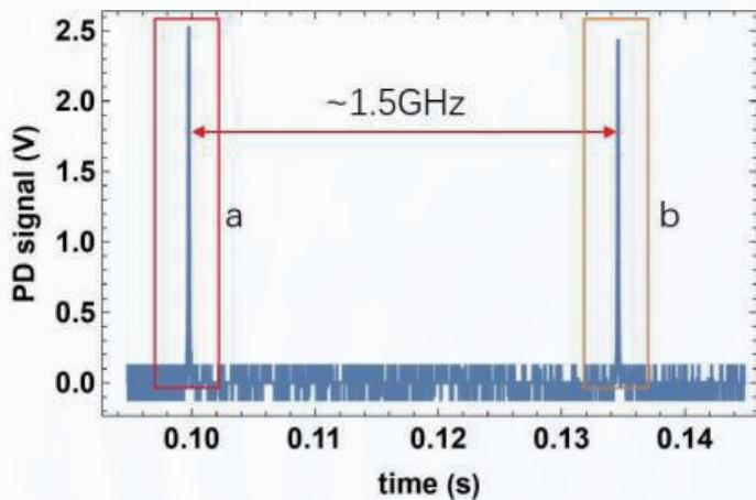
采用 1654nm 激光扫频时透射 PD 信号，注意此时没有进行仔细模式匹配，因此峰间隔 1.5GHz 左右。
