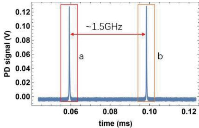
采用 1063nm 激光扫频时透射 PD 信号，注意此时没有进行仔细模式匹配，因此峰间隔 1.5GHz 左右。
