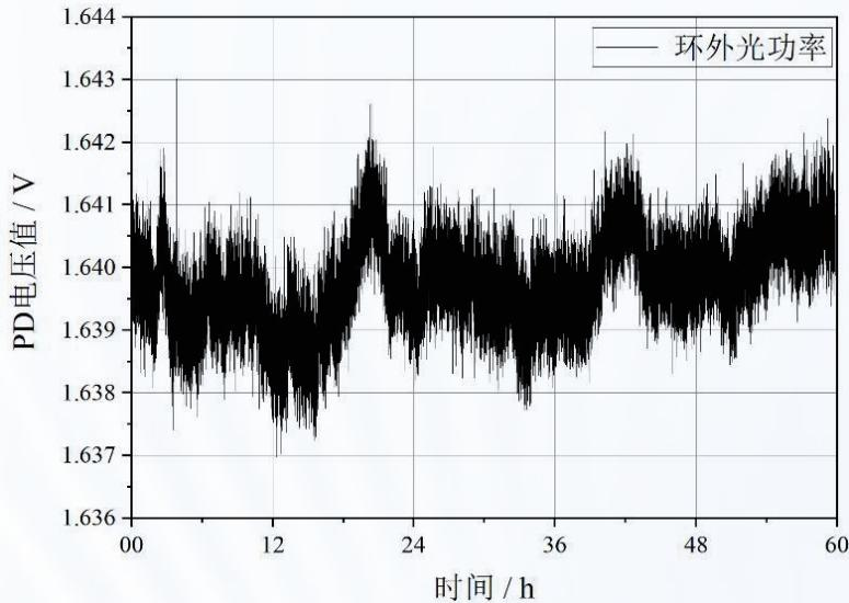
环外光功率测试结果。60h 数据 RMS 为 0.041%，前 24h 数据 RMS 为 0.043%，取平稳的 12h 数据 RMS 为 0.028%，均小于 0.05%。此数据测量时，环境温度波动较大(13°C-17°C)，实际会有更好的稳定度。
